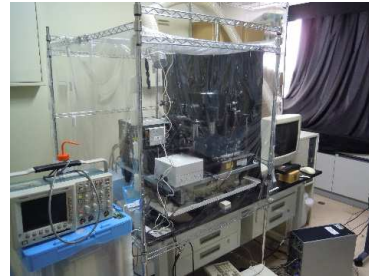
熱物性顕微鏡 不均質な試料の熱伝導分布を見ます
