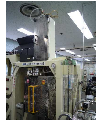
回転減衰振動式粘度計 高温金属融体の粘度を 測定します
